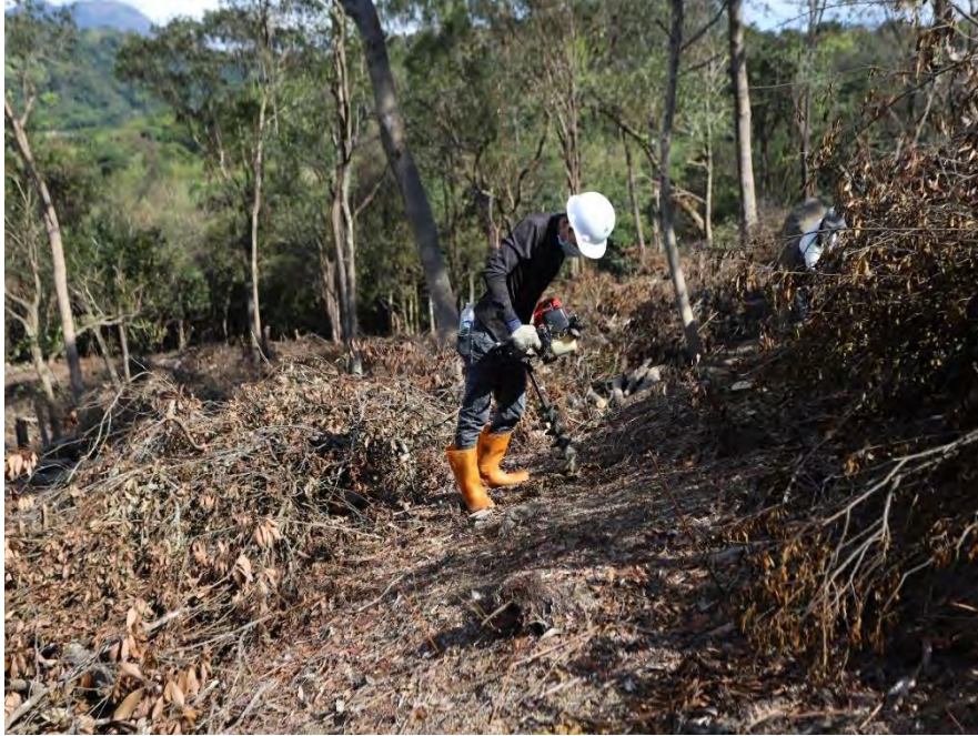
圖 26 以鑽洞機進行植穴開挖
